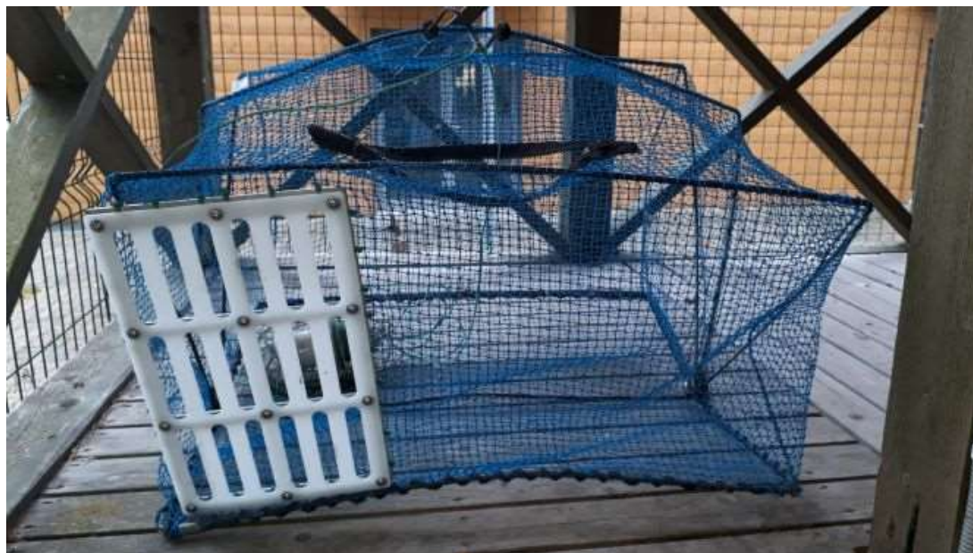
Joonis 43. Metallraamil vahetatavate selektiivsusakendega sump, mille peal tõmblukuga varustatud kalade sisse laskmise ja väljavõtmise ava.
