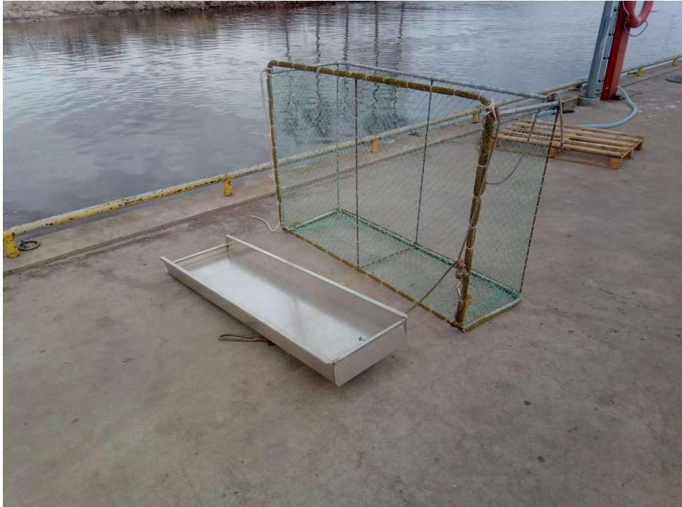
Joonis 81. RST terasest selekteerimisvann (alus) ja raamalusel võrk
