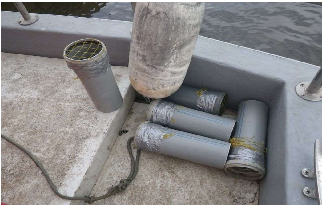
Joonis 74. Erineva läbimõõduga torud selektiivsema mõrralina kinnitamiseks.
