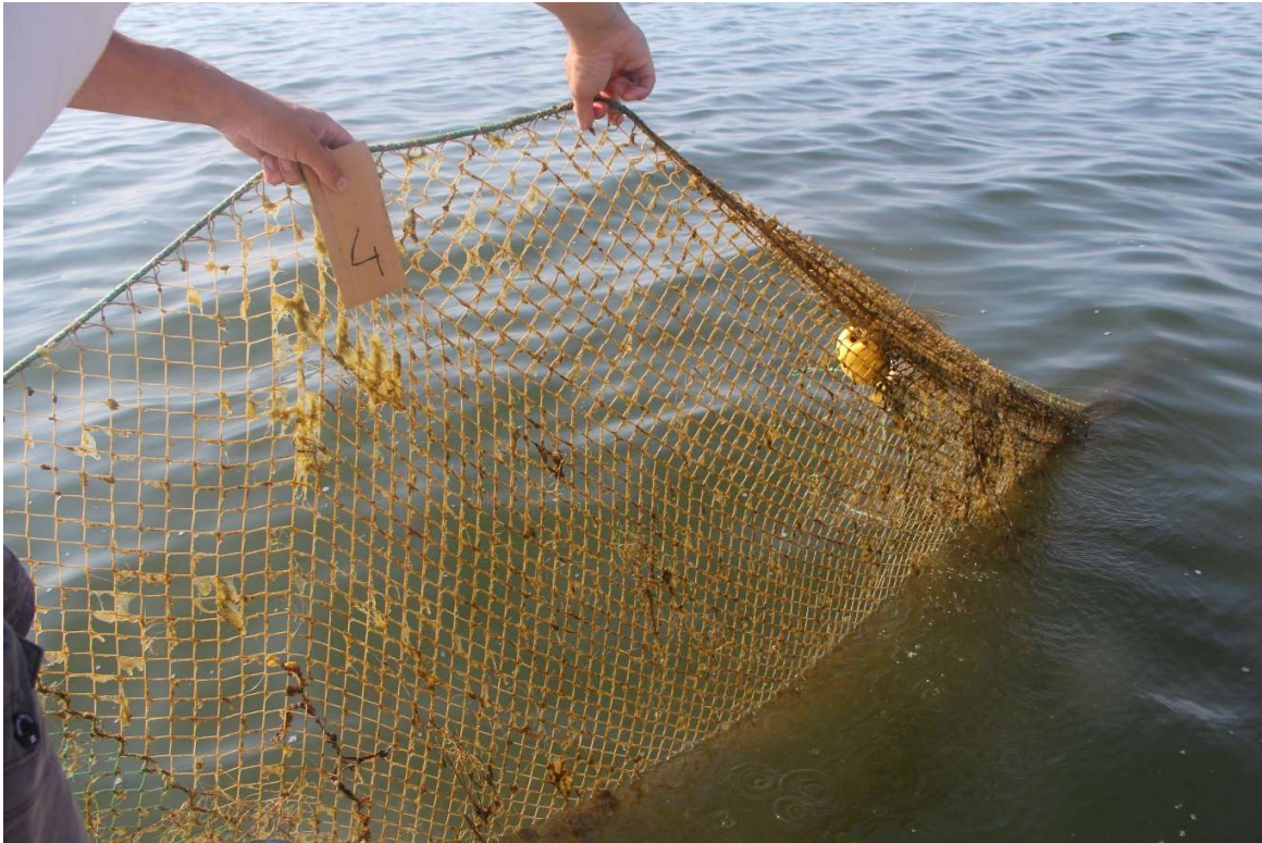
Joonis 32. Sõlmedeta kapron (polüamiid) noodalina Kuusnõmme lahes augustis 2018 aastal.
