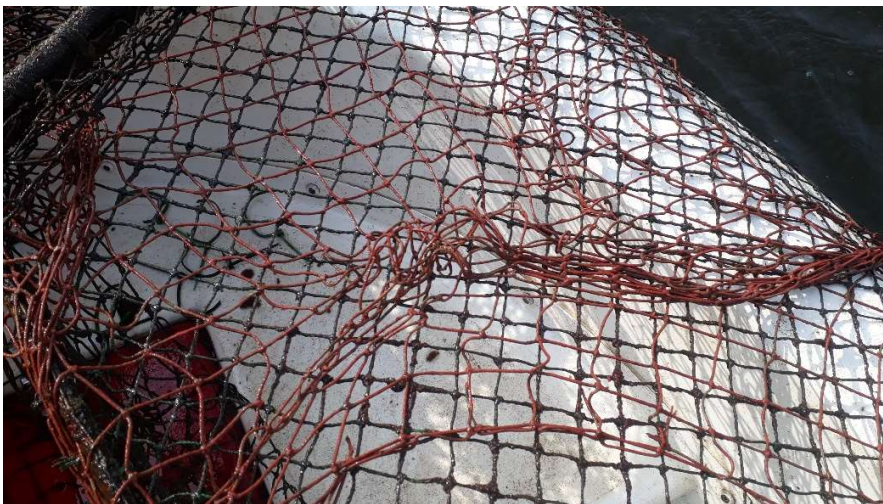
Joonis 57. Vagula järve paigaldatud immutatud mõrralina paneel (punane) võrdluses samast linast immutamata paneeliga (tume)
