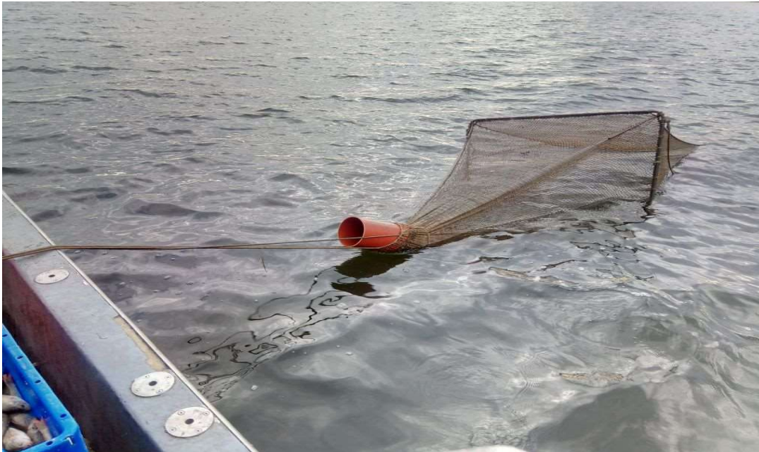
Joonis 77. Selektiivsustoru paigaldatuna ühkerelise mõrra kalakoti lõppu.
