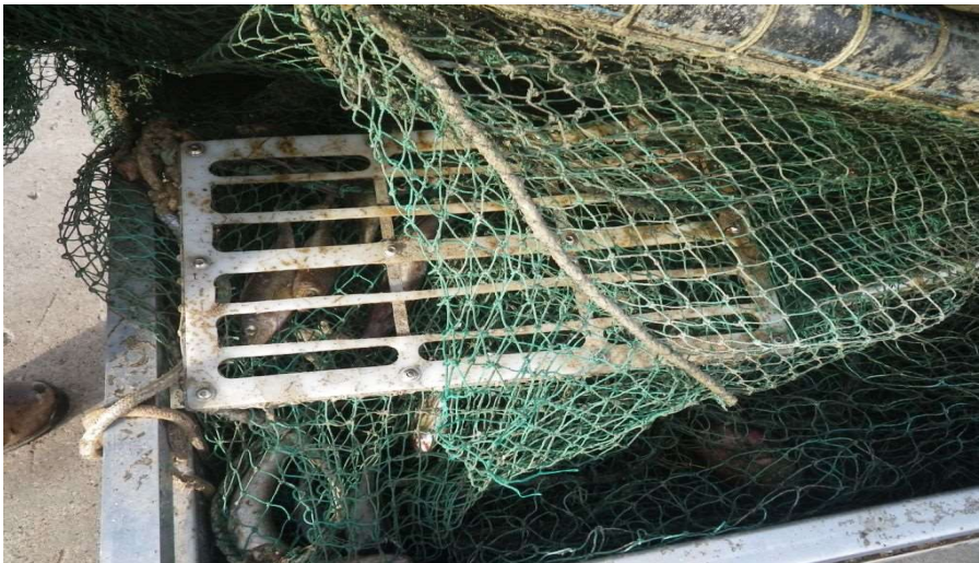
Joonis 73. Selektiivsusakend koos vahetatava silmasuurusega piludega raamiga paigaldatuna kahekerelise mõrra kalakoti külge.
