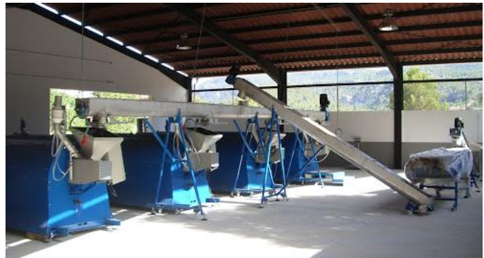
Joonis 60. Tööstuslik kompostireaktor, mida võib kaitluskohta paigaldada ka mitu.
