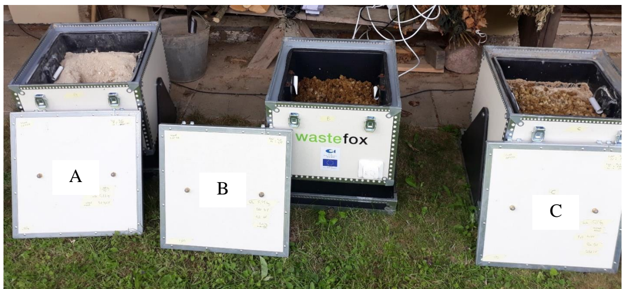
Joonis 54. Kompostisegud: a) peenkala ja pulbri 'Terra' segu, b) peenkala ja heinapelletite segu, c) peenkala, pulbri 'Terra' ja heinapelletite segu.
