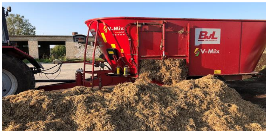
Joonis 47. Segamiseks kasutatud söödamikser BVL van Lengerich V-Mix 13 2S plus.
