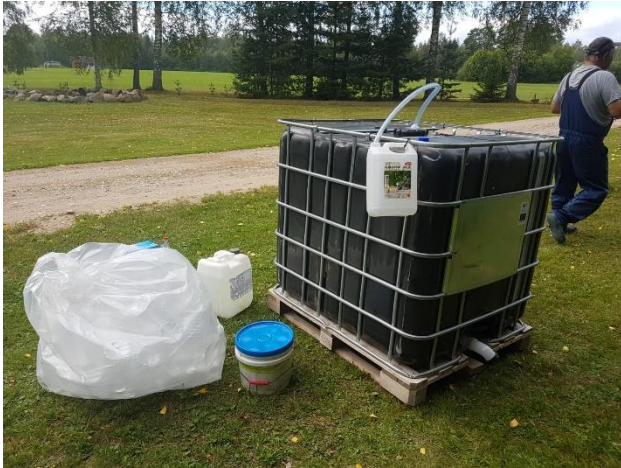
Joonis 69. Pildil on näha suuremahulise hüdrolysaadireaktori voolikust ja veekanistrist valmistatud õhulukk ning paremal lagunemata jäänud kalad.
