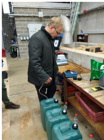
Joonis 65. Kalasuspensiooni hüdrolüüsimahutid ning nende monitooring gaaside sisalduse suhtes.
