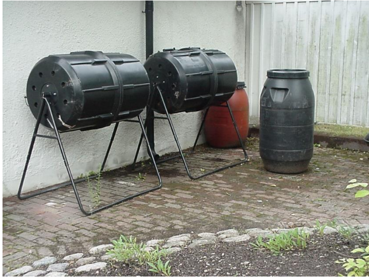
Joonis 59. Trummelkomposter ca 200 L ja trummelreaktor 50 L.
