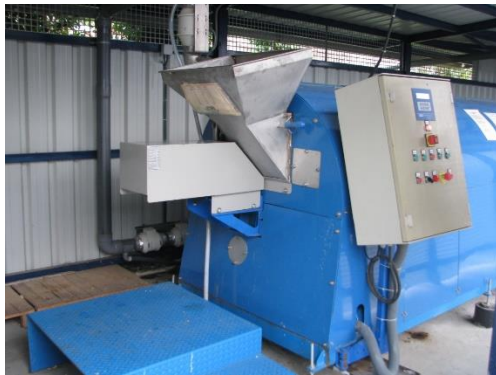
Joonis 60. Tööstuslik kompostireaktor, mida võib kaitluskohta paigaldada ka mitu.
