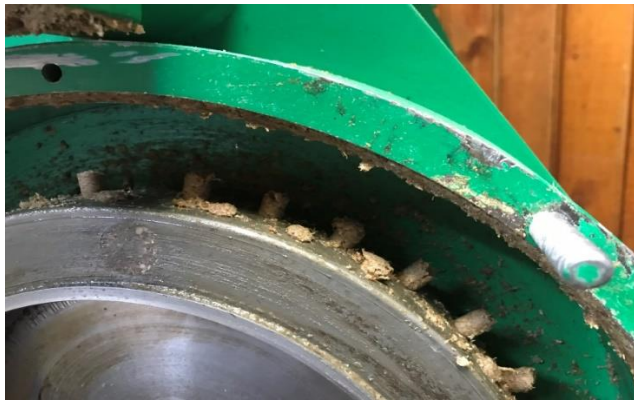
Joonis 32. Granuleerimisprotsess seadmega Farm Feed Systems Mini Press.
