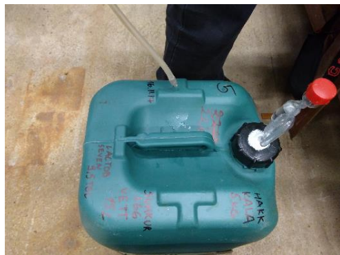
Joonis 65. Kalasuspensiooni hüdrolüüsimahutid ning nende monitooring gaaside sisalduse suhtes.
