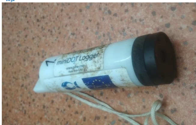
Joonis 3. PME miniDOT logger. Vee temperatuuri ja hapnikusisalduse registraator.
