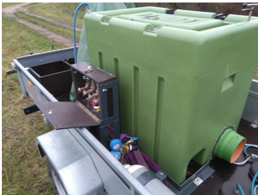
Pilt 1. Konteiner koos hapnikuballooni ja jaoturiga paigaldatuna kärule.
