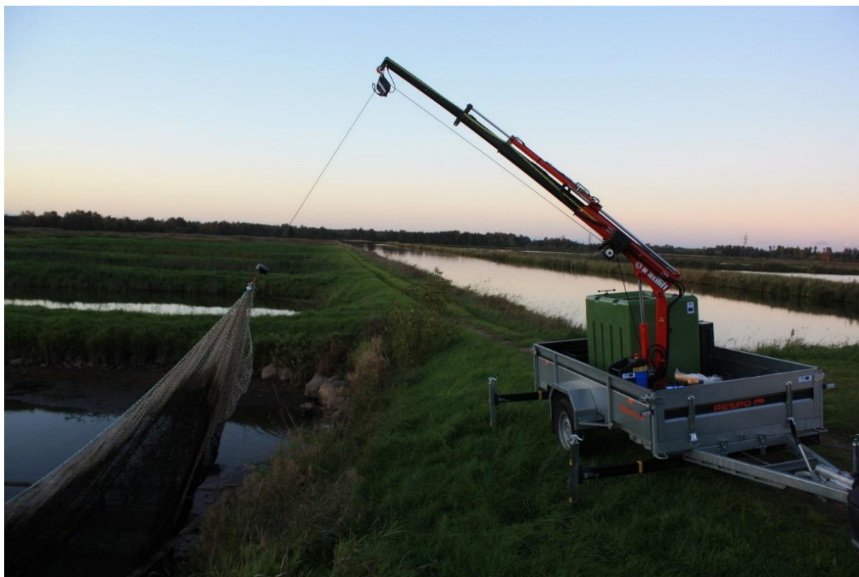
Pilt 4. Kraana kasutamine sumba väljatõstmisel.
