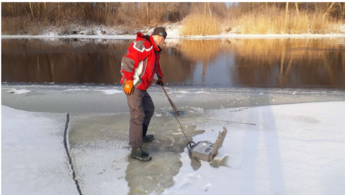
Foto 1. Emajõkke lastud akustiliste märgistega kohade jälgimine manuaalse vastuvõtjaga
