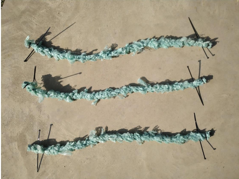
Joonis 1.1. Karbiliinide köienäidised erinevate substraatide efektiivsuse hindamiseks karbifarmides.
