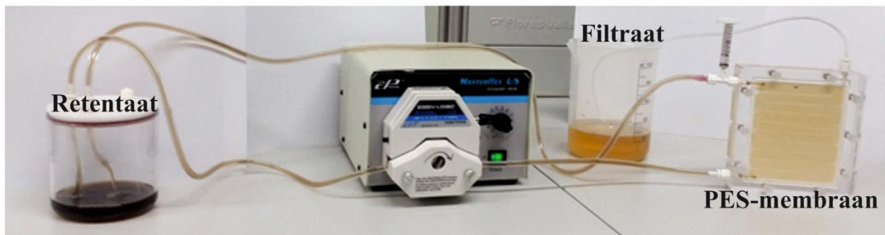
Joonis 3.6. Rannakarbi fraktsiooni F1 ensüümtöötus ja ultrafiltratsioon.
