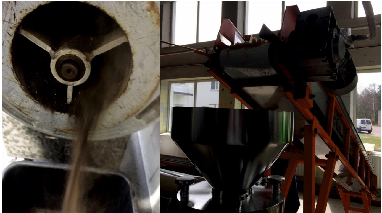
Joonis 3.16. Est-Agar AS tootmishoones kasutusel olev töndluslik haklihamasin, millega saab karpe purustada (vasakul) ning granulaator, millega saab purustatud korbimassi või proteiinipulbrit siduda sideaine abil vajaliku suurusega osisteks (paremal), juhul kui soovime korbimassist toota näiteks kalasööta.
