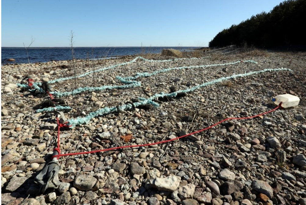
Joonis 1.9. Merepõhja paigaldatud köieliinid, millel mõõdistasime regulaarselt täiskasvanud karpide kinnitumise intensiivsust.
