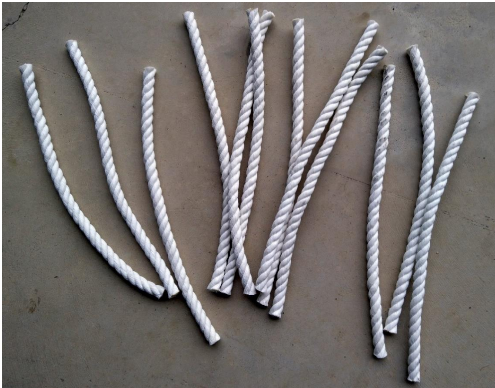
Joonis 1.4. Biolagunevast materjalist köis testimaks mikroplastivaba kasvusubstraadi kasutamise potentsiaali Tagalahe karbifarmis.
