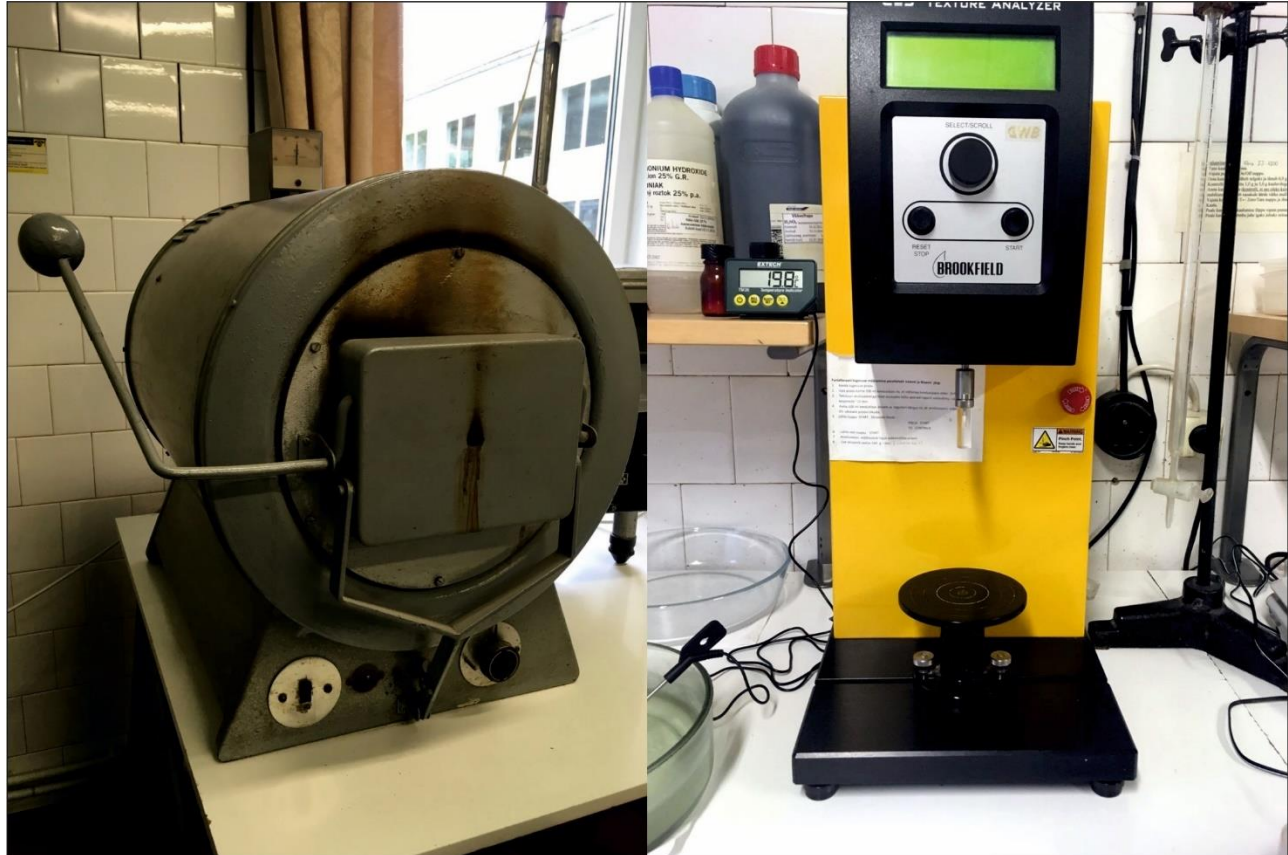
Joonis 3.17. Est-Agar AS laboris kasutusel olev kuivatusahi, mille abil uuriti kuivatusperioodi pikkuse mõju proteiinipulbri niiskuse sisaldusele (vasakul) ning saagise tekstuuri analüsaator, millega hinnati ekstrahheeritud materjali erinevaid omadusi (paremal).
