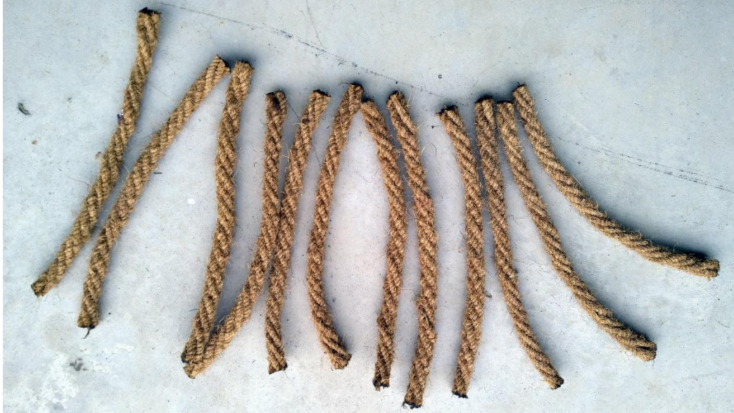
Joonis 1.3. Kookoskiust köis testimaks mikroplastivaba kasvusubstraadi kasutamise potentsiaali Tagalahe karbifarmis.
