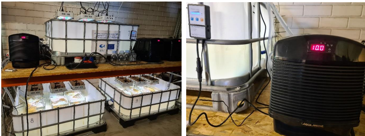
Joonis 3.3 Jahutusmahutid ja AQUAMEDIC jahutid
