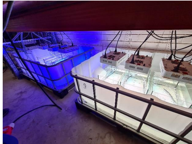
Joonis 3.4. Akvaariumide valgustamine LED lampidega
