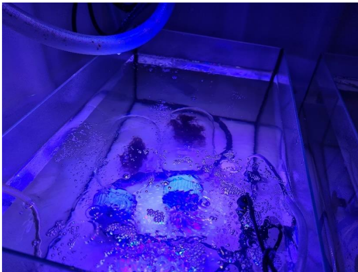
Joonis 2.1.1. Netofotosünteesi mõõtmine
