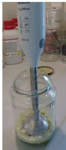
Joonis 30. Želatiini purustamine nuimikseriga.
