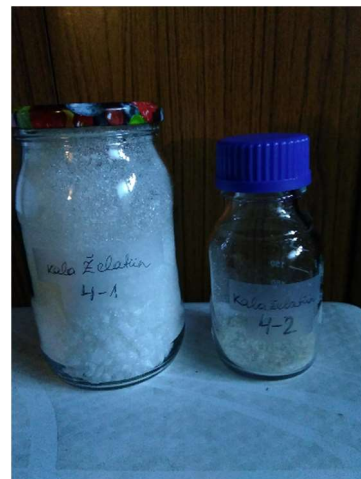
Joonis 31. Suuremas purgis lüofiliseeritud ja kohviveskis purustatud želatiin; väiksemas purgis kondensats. kuivatis moodustunud želatiinilehed nuimikseriga purustatud. Mõlemas purgis on sama kaaluga želatiinimass.
