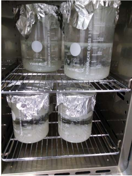
Joonis 15. Kalasoomusemass ahjus destilleeritud vees inkubeerumas (želatiini ekstraheerimise etapp)
