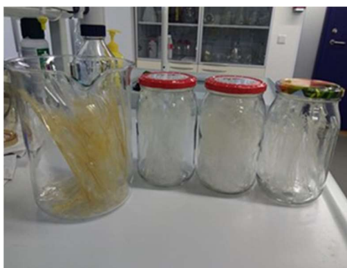
Joonis 28. Erinevate kuivatusviiside mõju želatiinilehtede värvusele (kollakam – kuumkapis 70°C juures kuivatatud želatiin; värvusetu – kondensatsioonkuivatis kuni 49°C kuivatatud želatiin)
