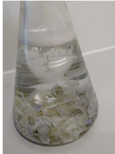
Joonis 9 Ahvenanahatükid 1M HCl lahuses. Lahus on selge, kalanahatükid punduvad.
