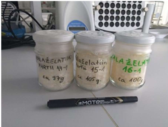
Joonis 32. Kondensatsioonkuivatis kuivatatud želatiinilehed nuimikseriga purustatult. Partiid 14, 15 ja 16. Saagised varieeruvad ligikaudu 100 g juures 2 kg kalanahkade kohta.
