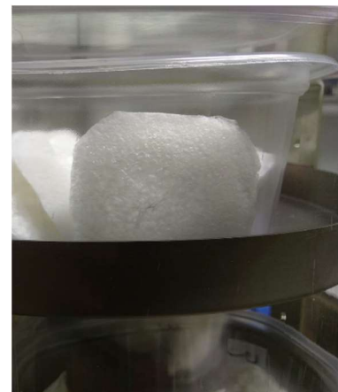
Joonis 24. Lüofiliseeritud želatiin on õhuline ja kerge.
