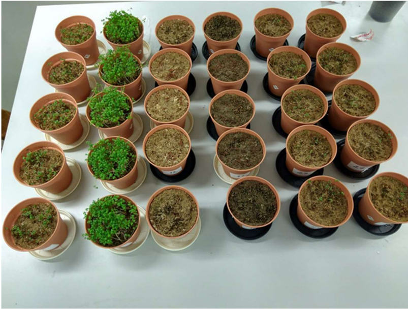
Joonis 33. Salatkressi kasvukatse. Katsevariandid vasakult paremale: 1) kontrollkatse põhisubstraadiga, 2) põhisubstraat + järvesete, 3) põhisubstraat + želatiinijääkidega soomused, 4) põhisubstraat + järvesete + želatiinijääkidega soomused, 5) ja 6) – põhisubstraat + alternatiivne veesidumismaterjal.
