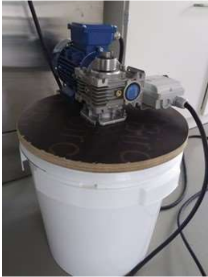
Joonis 10. Seade kuni 30 l kalajäägisuspensiooni segamiseks
