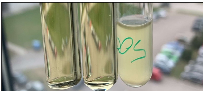
Joonis 43. Ilma kasvuta želatiini proovid (17-1) vs positiivne kontroll.
