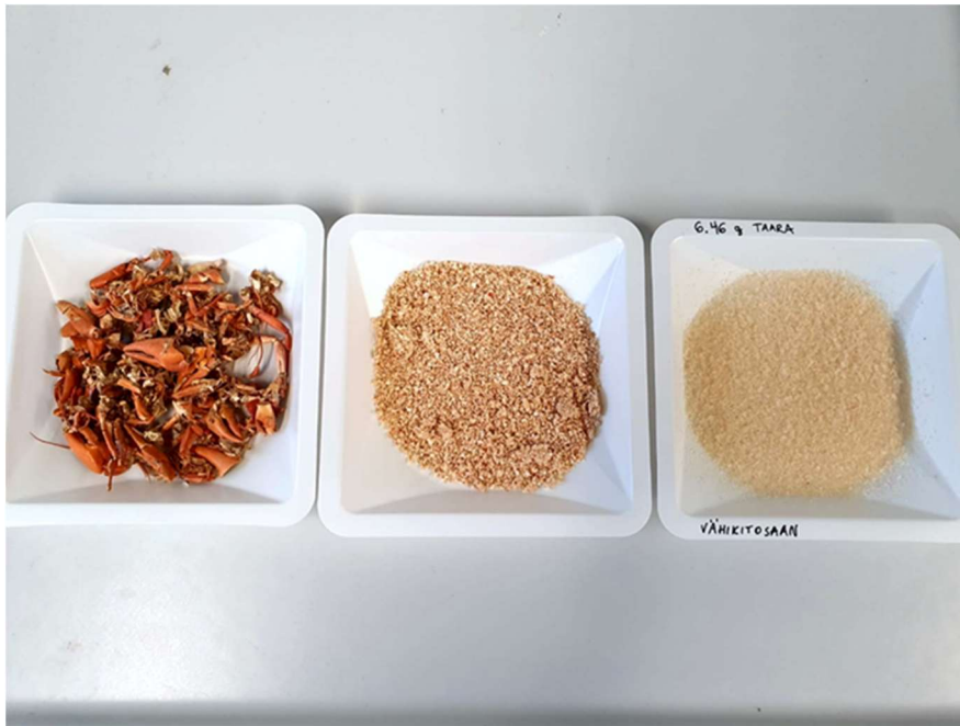
Joonis 56. Pildil vasakult paremale – deproteiniseeritud vähijäägid, purustatud ja demineraliseeritud materjal (kitiin) ning kitosaan.
