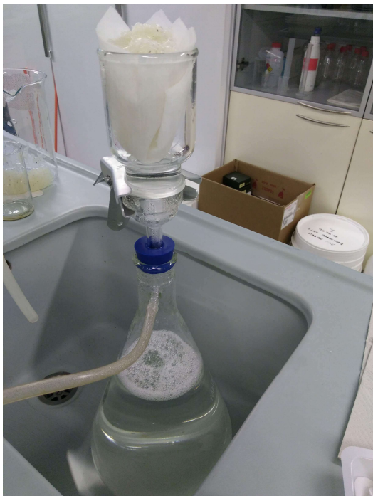
Joonis 18. Vaakumfiltreerimine läbi klaasfiiberfiltri koos eelpuhastamisega läbi filterkoti materjalist eelfiltri
