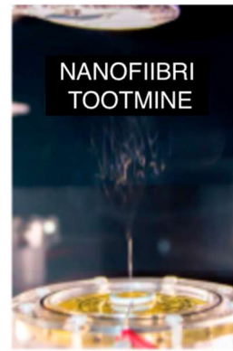
Joonis 41. A) Ultraheli – elektrospinnimise (USES) skeem, (B) USES-süsteemi ja protsessikeskkonna foto (kliimakambris) ja (C) lähivõtte nanokiudude moodustumisest USES protsessis. Kohandatud (Hakkarainen et al. 2019).
