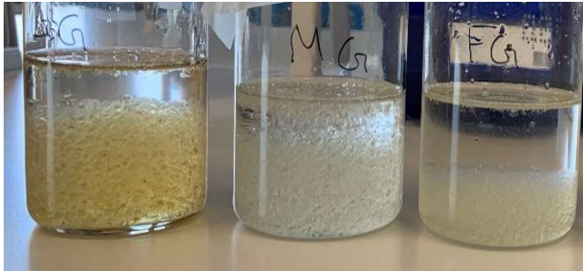
Joonis 34. Pundumise faasis kontrollproovide vesilahused, vasakult GG, MG ja FG.
