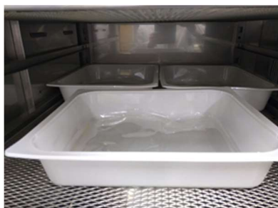
Joonis 26. Želatiini kuivatamine kondensatsioonkuivatis
