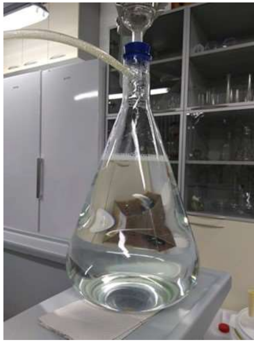
Joonis 19. Pärast filtreerimist läbi Whatman GF/F filtri saadud läbipaistev värvitu želatiinilahus
