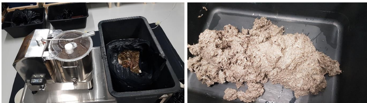
Joonis 11. Kalajäätmete purustamine purustiga vasakul ja purustatud kalajäätme paremal.
