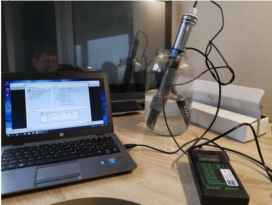
Joonis 16. Hapnikulogerite kalibreerimine.
