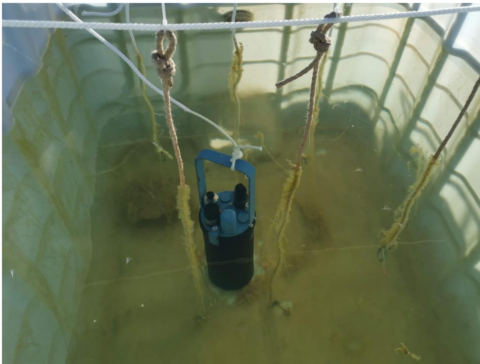
Joonis 17. Vee parameetrite mõõtmine CTD sondiga 2019. aasta mais.
