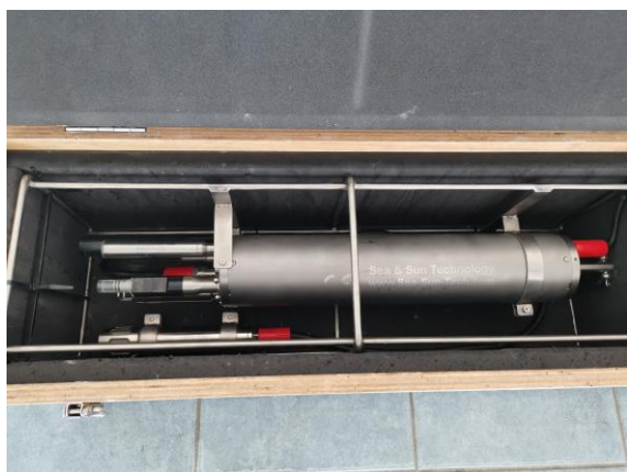
Joonis 19. SSN M90 sond, mida kasutati loodusliku vetikakoosluse keskkonningimuste kirjeldamiseks ja inkubeerimismahutite eri parameetrite jälgimiseks.
