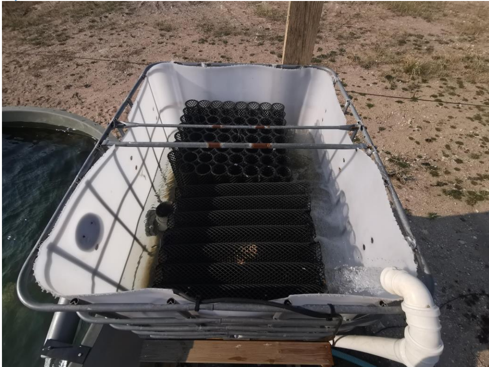
Joonis 13. Eksperimendi seadistamine (aprill 2019). Sissetuleva vee aeraator ja sademefilter.
