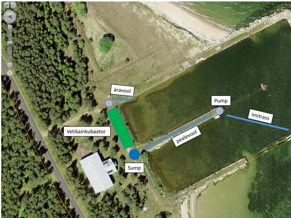
Joonis 2. Ekspirimendi paigutuskeem Kesknõmme kalakasvatuse territooriumil – eialgne versioon.
