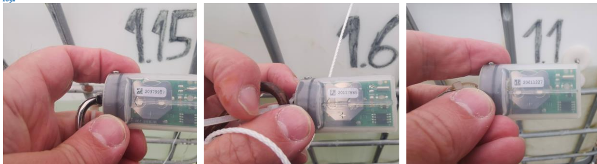
Joonis 18. Automaatsete valgus- ja temperatuurilogerite paigaldamine mahutitesse (2020. aasta esimene eksperiment, 08.06.2020).
